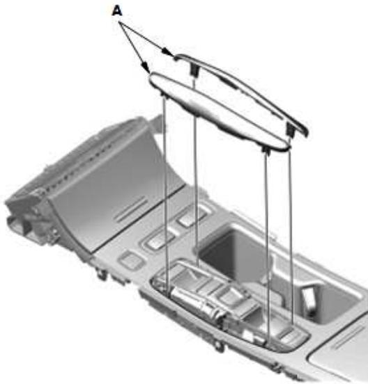
2. 拆下 SBW 换档器总成 (A) 和电子驻车制动器开关总成 (B)。
